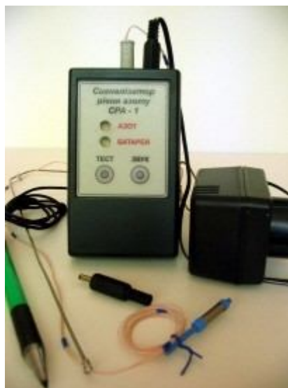
Рис. 1. Сигналізатор рівня азоту CPA-1 призначений для цілодобового вимірювання рівня рідкого азоту в посудинах Дьюара
