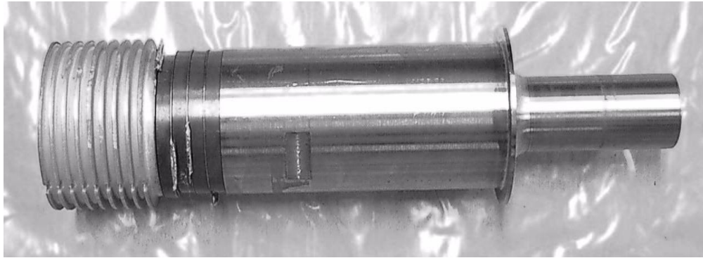
Рисунок 3.4. УЗ-випромінювач з однохвильовою акустичною системою і ступінчастим трансформатором швидкості
