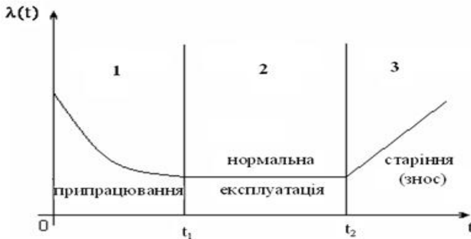
Рисунок 3. – Залежність інтенсивності відмов від часу роботи ТЗ
