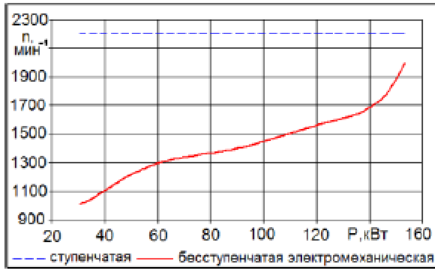
Рисунок 4.3 - Закон управління оборотами ДВС в залежності від використовуваної потужності на ТД з мінімальною витратою палива
