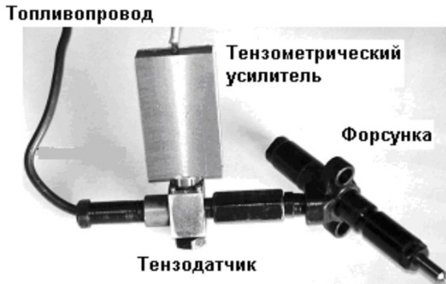
Рис. 3.4. Тензометричний датчик тиску, що встановлений перед форсункою
