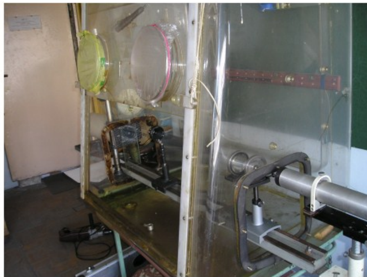
Рис. 3.2. Дослідна установка для вимірювання фізичних параметрів форсунки дизельного двигуна.
