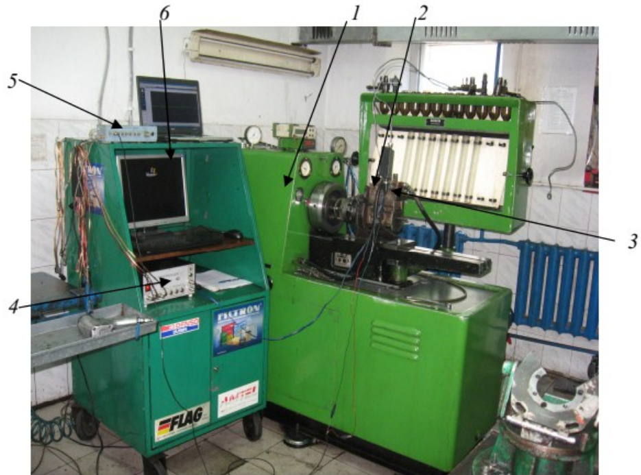
Рис. 3.1. Дослідна установка для зняття кривої тиску впорскування: 1 – стенд для регулювання паливних насосів високого тиску, 2 – еталонний паливний насос, 3 – тензодатчик тиску, 4 – підсилювач сигналу, 5 – електронний осцилограф, 6 – персональний комп'ютер
