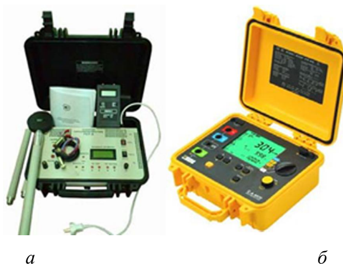
Рис. 5.4. Прилади для контролю стану ЗП: а – «КДЗ-1У»; б – С.А 6470N
