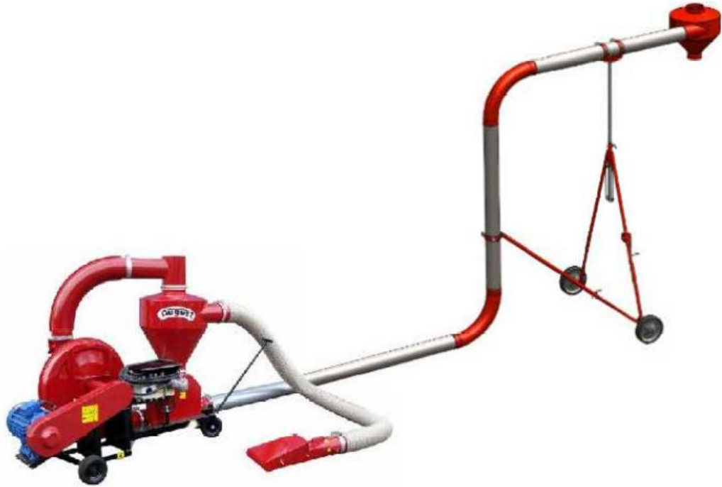
Рис. 1.2. Приклад всмоктувально-нагнітальної системи пневмотранспорту.
