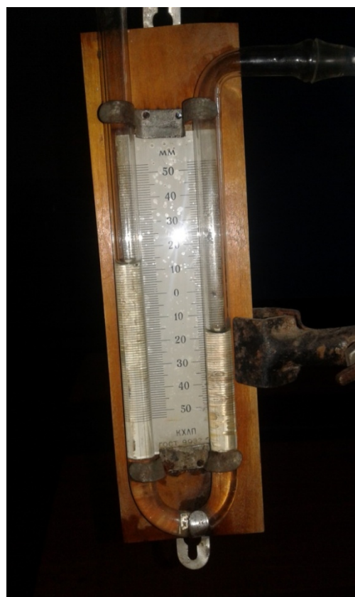
Рис. 3.13. Вимірювання статичного тиску в трубопроводі пневмотранспортера.
