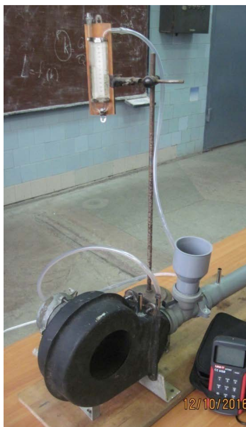
Рис. 3.13. Вимірювання статичного тиску в трубопроводі пневмотранспортера.
