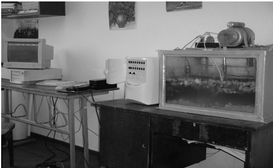
Рис. 3.5.– Загальний вигляд експериментальної установки для дослідження впливу коливань на інтенсивність тепловіддачі
