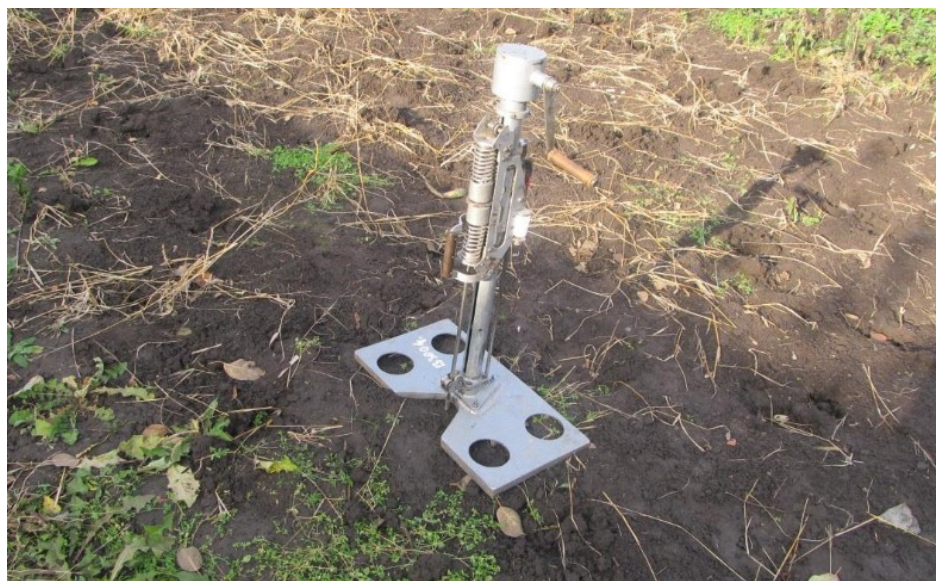
Рисунок 3.6 – Твердомір конструкції ВИСХОМ.
