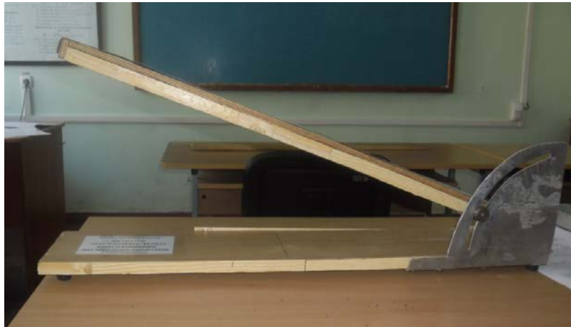
Рис.2.1 Установка для визначення коефіцієнта тертя
