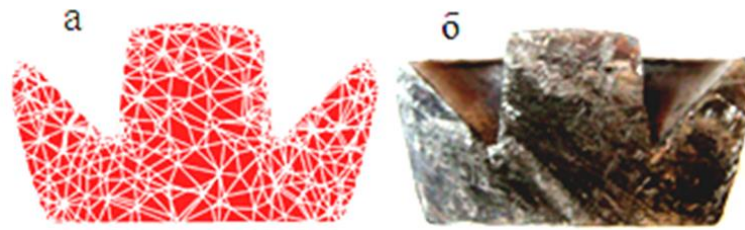
Рисунок 3.7 - Порівняння геометрії отриманих зразків після 1-ої стадії:
