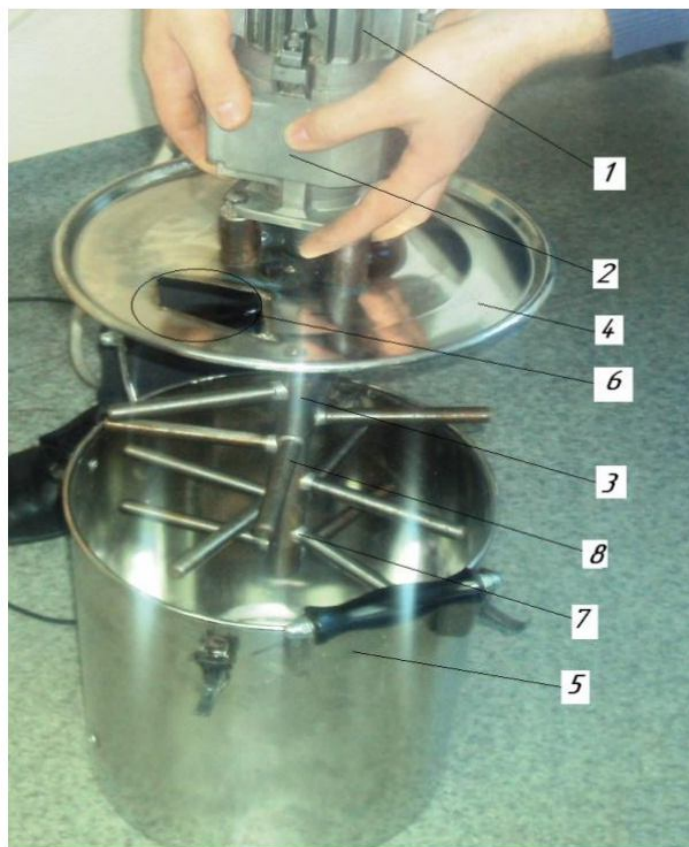
Рисунок 3.12 - Загальний вигляд експериментальної тістомісильної машини: 1 - електродвигун; 2 - двоступеневий редуктор; 3 - вертикальний робочий орган; 4 - кришка місильної ємності; 5 - місильна ємність; 6 - оглядове вікно; 7 - втулка; 8 - робоча лопать
