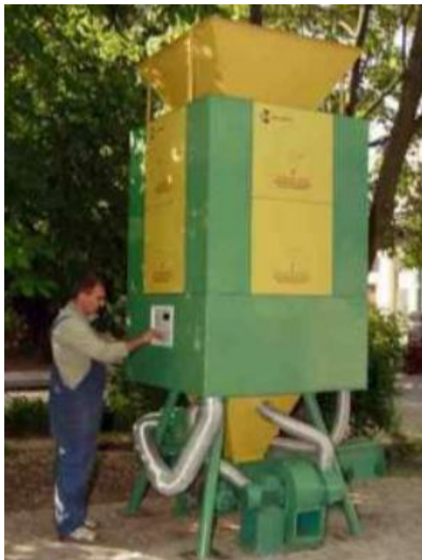
Рисунок 1.7 - Установка мікрохвильова для сушіння зернових та олійних культур
