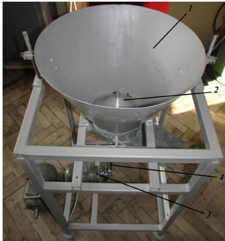
Рисунок 3.2. Експериментальна установка вібраційного об'ємного дозатора
