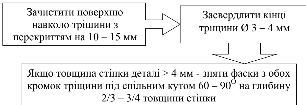
Рис.2.10 Послідовність підготовки тріщини до заварювання
