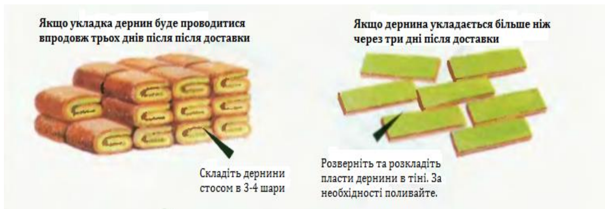
Рис. 4.10. Підготовка пластів дерну до укладки на об'єкті
