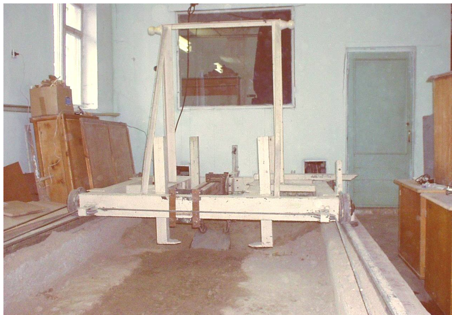
Рис. 3.3. Загальний вигляд ґрунтового каналу з динамометричним візком.
