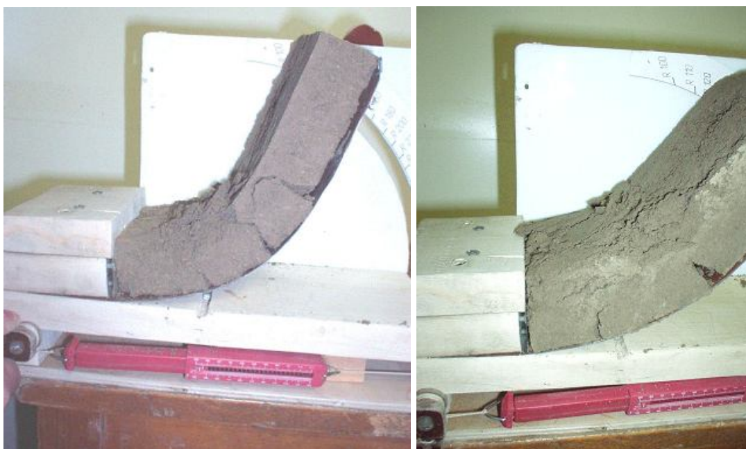
Рис. 3.8. Визначення співвідношення зони стиску до зони розриву ґрунтових зразків
