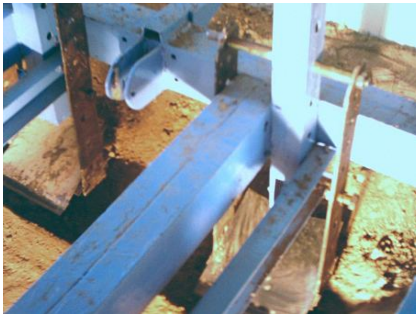
Рис. 3.5. Навіска дослідного обладнання на динамометричний візок
