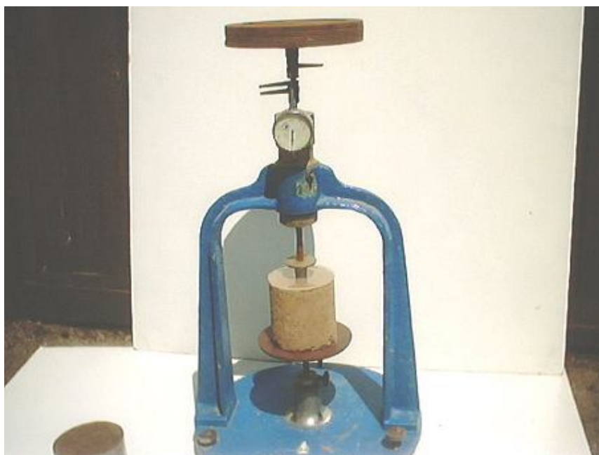
Рис. 3.2. Пристрій для вимірювання відносних деформацій ґрунту:
