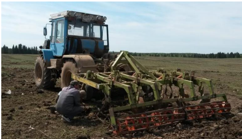
Рисунок 3.7 - Остаточне регулювання в полі після пробного проходу культиватора КСТ-3,8.
