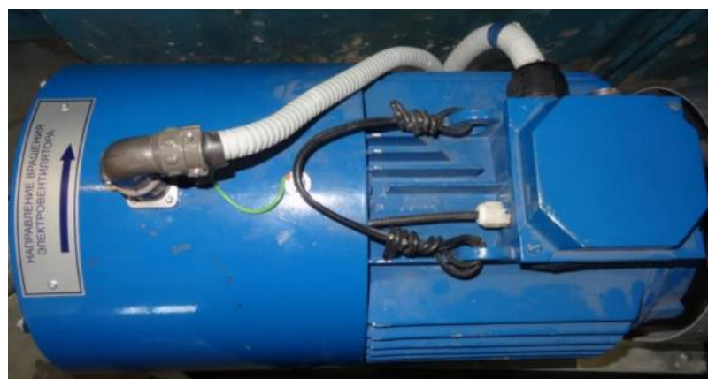
Рисунок 3.2 - Асинхронний короткозамкнений двигун з примусовою вентиляцією ДАР 112 М4 буз-ІМ1081-ІТ02500-В.
