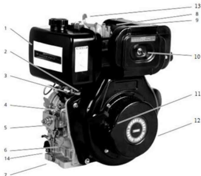
Рисунок 3.5 - Дизельний чотиритактний двигун GREENFIELD GF178 F: 1 - паливний бак; 2 - пробка отвору для зливу палива; 3 - паливний кран; 4
