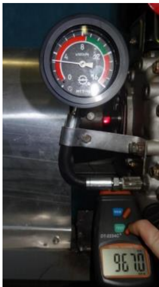
Рисунок 3.6 - Цифровий тахометр DT-2234C + і манометр МТТ-16 для стенду для обкатки та випробувань ДВЗ МГТ.
