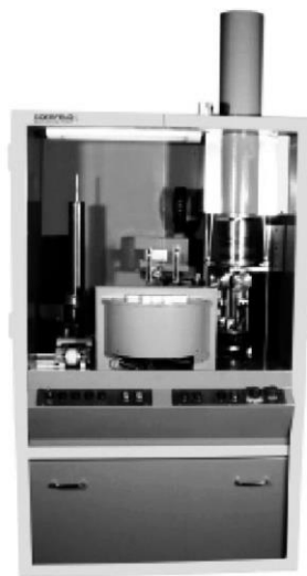
Рис. 2.8. - Вимірювальна установка для визначення реологічних і тепло-фізичних характеристик Coesfeld RT1394H
