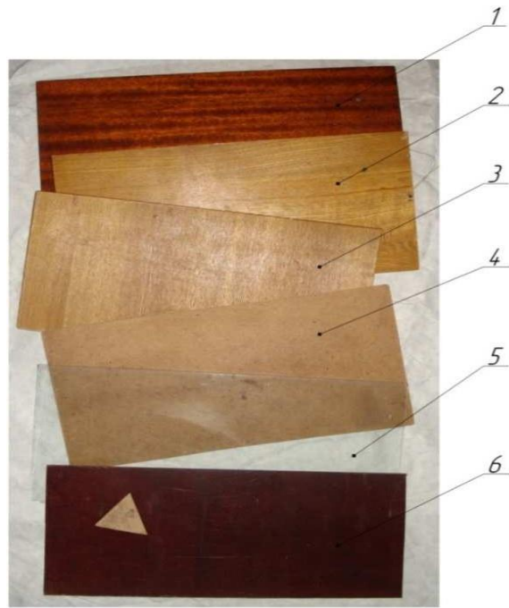
Рис. 2.7 - Змінні поверхні тертя конструкційних матеріалів: 1 - ДСП з синтетичним водостійким покриттям; 2 - дерево вздовж волокон; 3 - дерево поперек волокон; 4 - ДВП водостійка з полірованою поверхнею; 5 – скло, що не б'ється; 6 - склотекстоліт ГОСТ 12052-67
