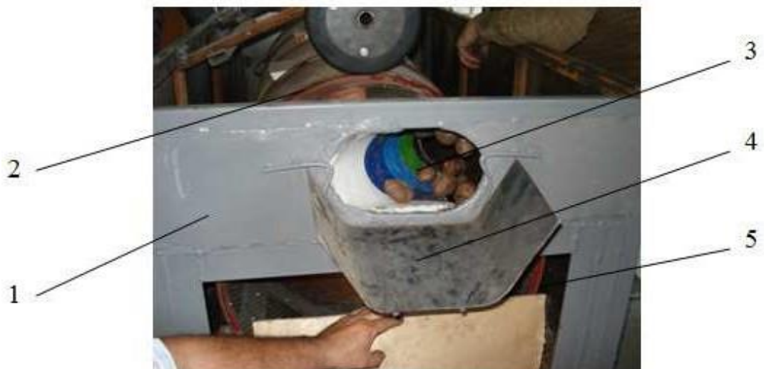
Рис. 4.1 - Фрагмент лабораторно-виробничої установки для мийки коренебульбоплодів: 1 - ванна; 2 - барабан; 3 - вивантажний скребок; 4 - вивантажний лоток; 5 - прозора стінка
