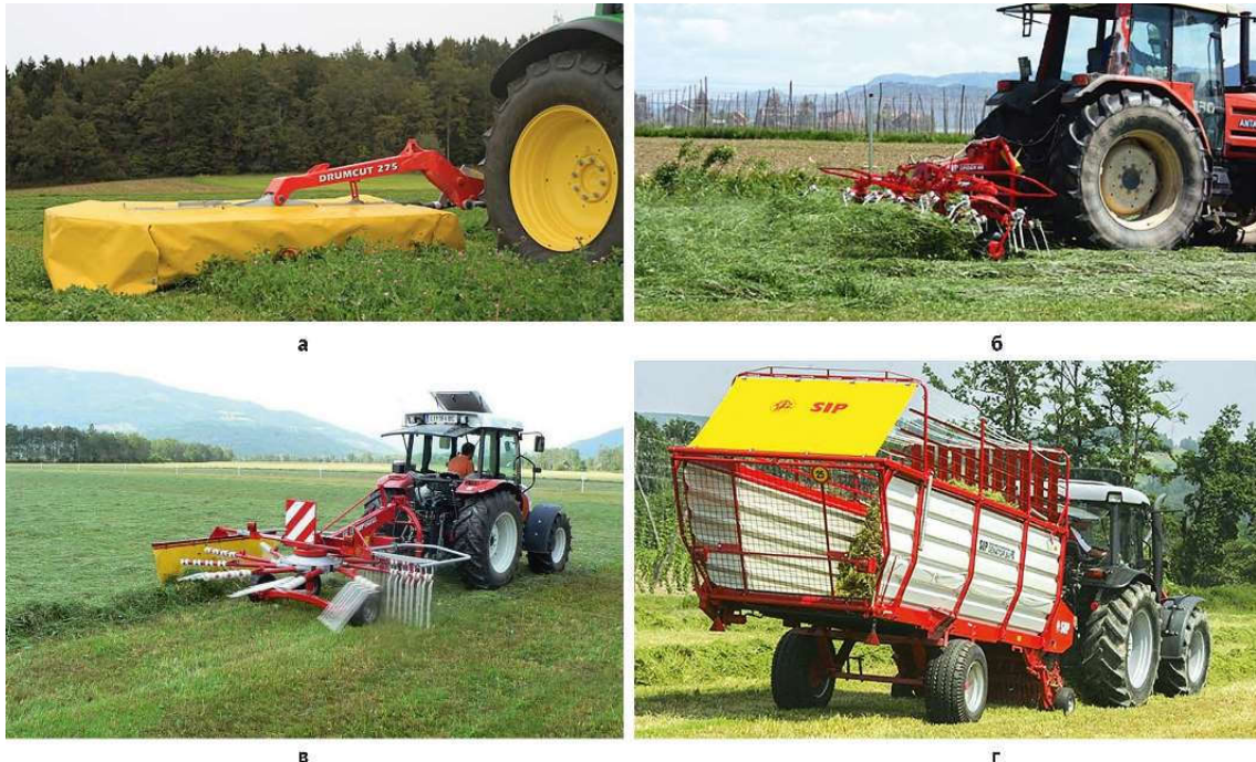
а) косарка навісна барабанна DRUMCUT 275; б) зворушувач-спушувач SPIDER400 HGP; в) валкоутворювач STAR360/10; г) при- іп-підбирвач SENATOR28-9
