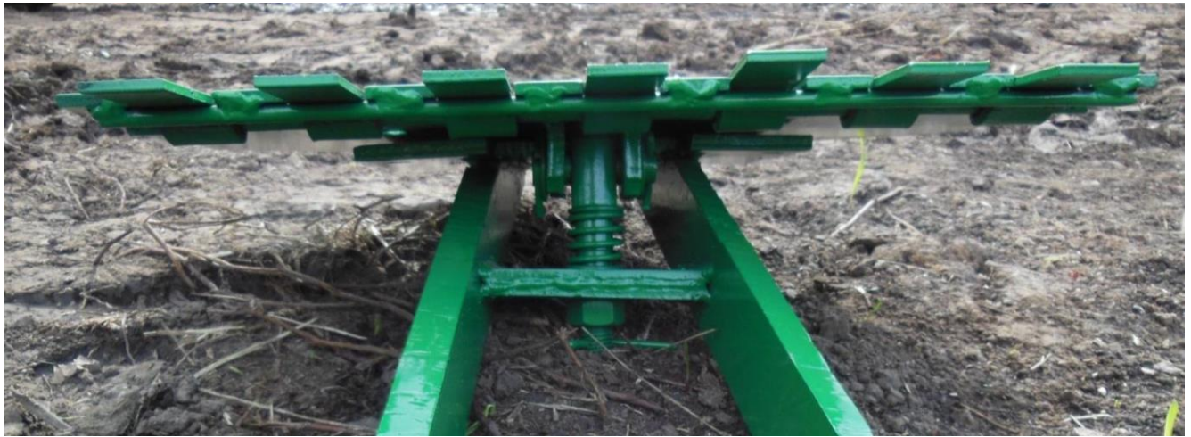
Рис. 3.2. Загальний вигляд пружинного механізму вдосконаленого підкопуючого робочого органу
