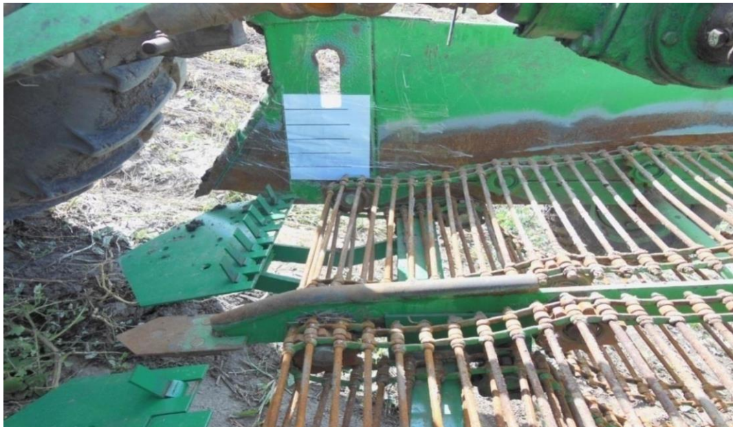
Рис. 3.4. Загальний вигляд вимірювальної шкали для фіксації висоти підскоку компонентів
