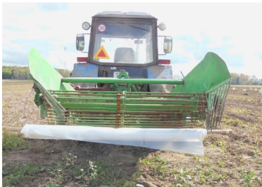
Рис. 4.4. Вдосконалений картоплекопач КТН-2В під час визначення повноти збирання (вигляд ззаду)
