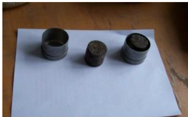
Рис. 3.8 - Зразки досліджуваного ґрунту, що поміщені в бюкси
