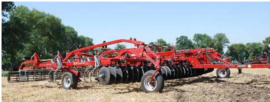
Рис. 1.12 - Дисковий культиватор Wil-Rich DC III
