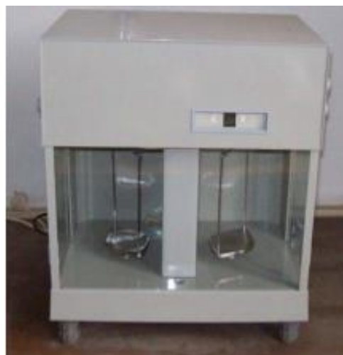
Рис. 3.9 - Лабораторні ваги ВЛР-200
