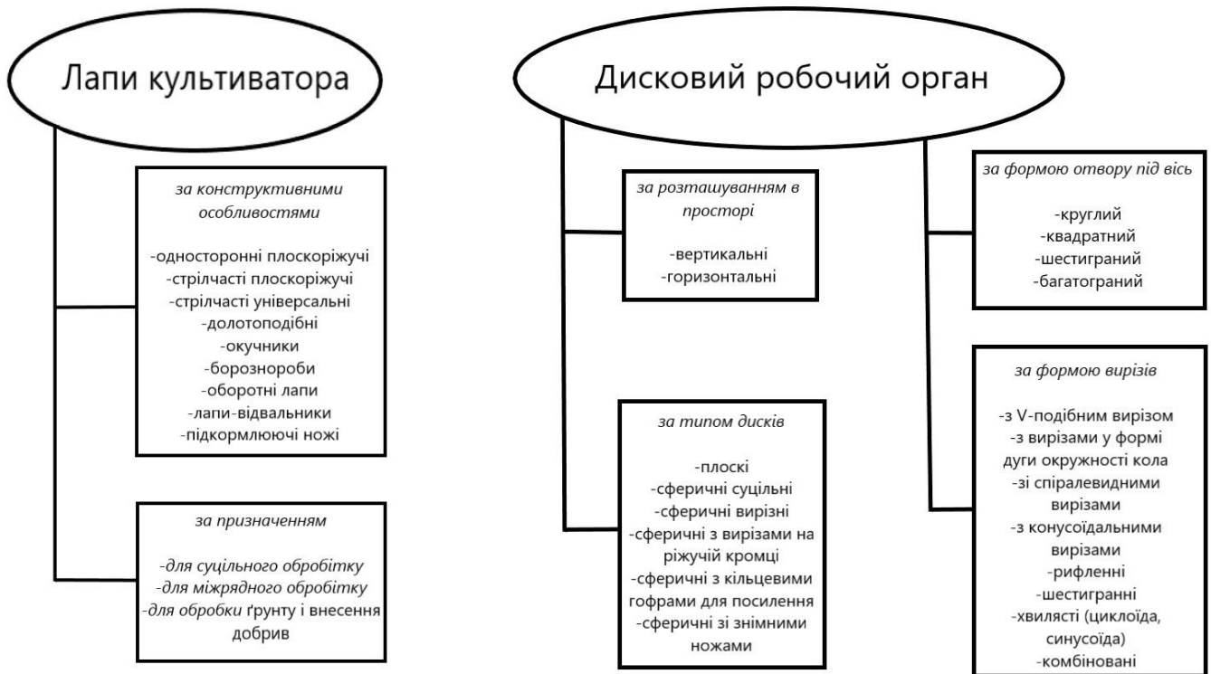
Рис 1.1 - Класифікація робочих органів для поверхневого обробітку ґрунту
