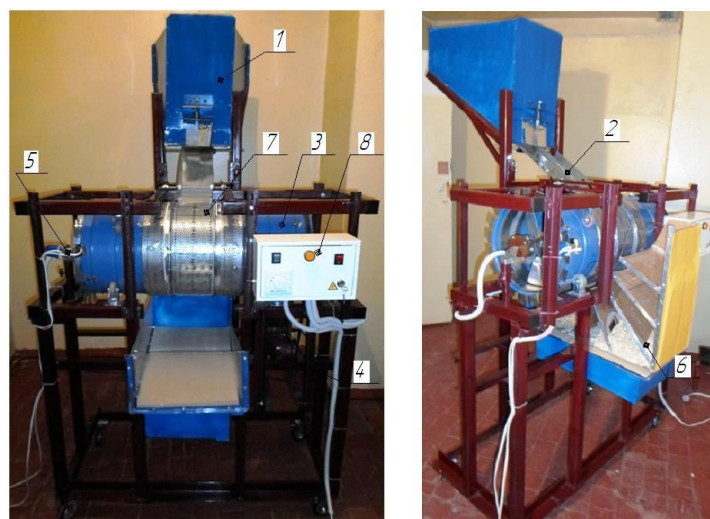
Рис. 3.5 - Експериментальний аеродинамічний сепаратор з циліндричною сепаруючою поверхнею: 1 – бункер; 2 – лоток; 3 – камера з вентиляторами; 4 – привод барабана; 5 – датчик частоти обертання барабана; 6 – бункер розділеного насіння; 7 – решето; 8 – щиток керування
