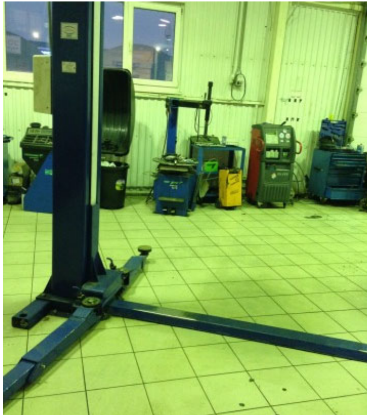
Рисунок 1.11 – Підйомник для автомобілів на дільниці з ремонту і обслуговування легкових автомобілів у ТОВ «Вінницьке АТП 10556»
