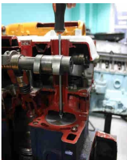
Рисунок 3.9 - Спосіб установки змінних жиклерів в днище поршня через свічковий отвір двигуна ЗМЗ-4062.10
