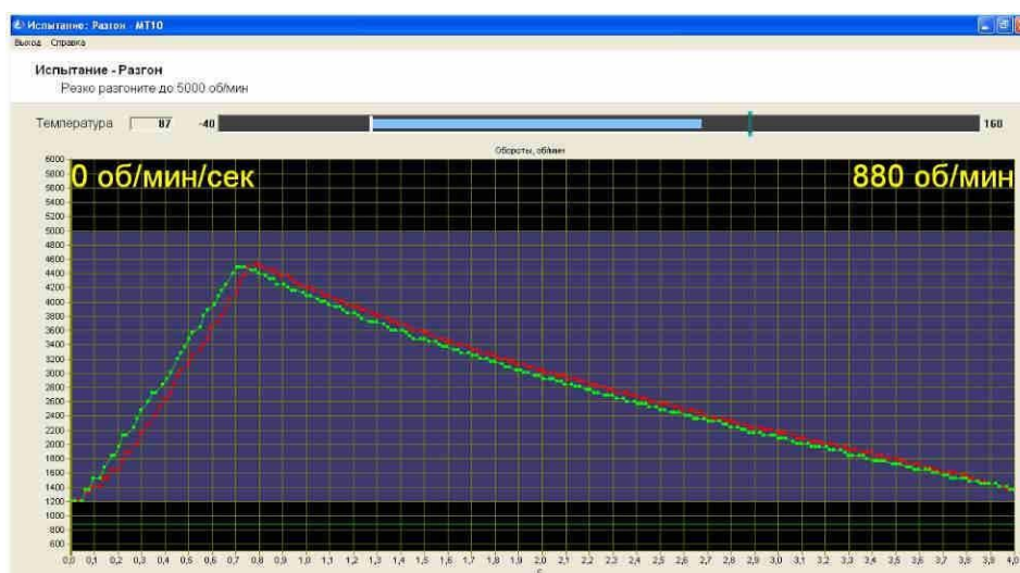
Рисунок 1.12 - Вікно мотор-тестера МТ-10 в режимі тесту «Розгін»
