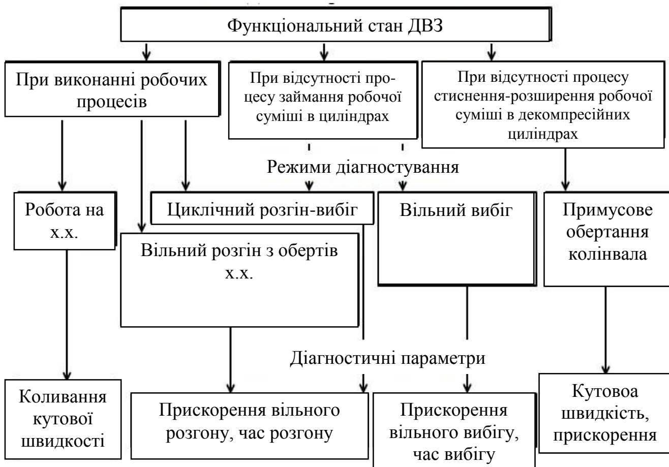
Рисунок 1.5 - Схема режимних ознак динамічного методу для ДВЗ з іскровим запалюванням
