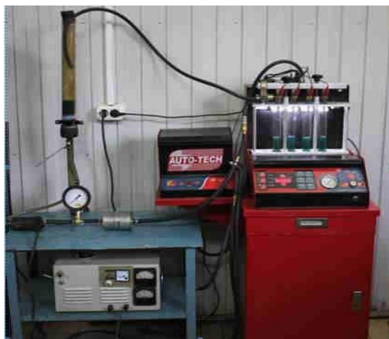
Рисунок 3.11 - Загальний вигляд установки для промивання і тестування бензинових форсунок і перевірки електробензонасосів.
