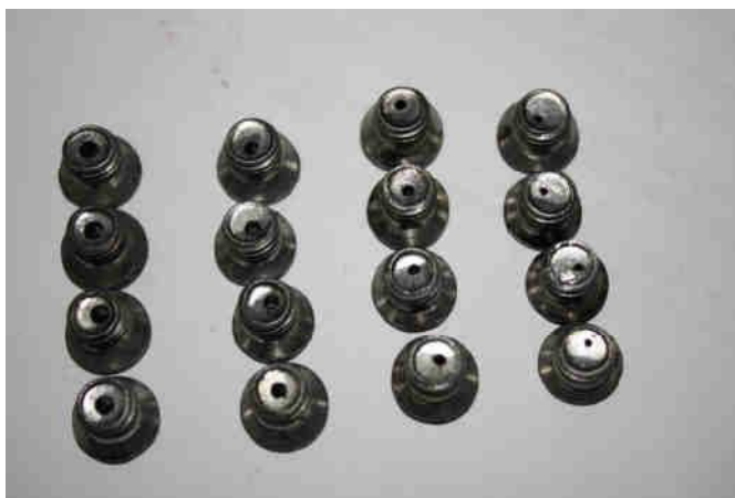
Рисунок 3.10 - Змінні жиклери для установки в днище поршня
