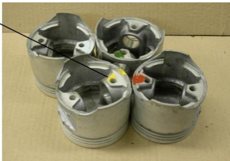
Рисунок 1.8 - Маркування поршнів під поршневий палець
