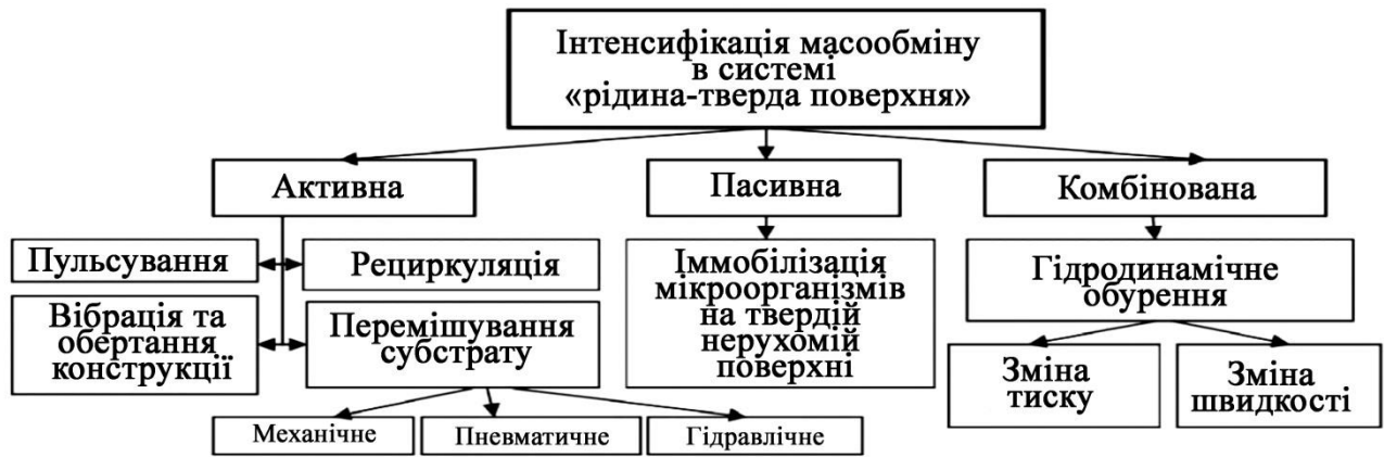
Рис. 1.6 - Інтенсифікація масообміну в системі «Рідина - тверда поверхня»
