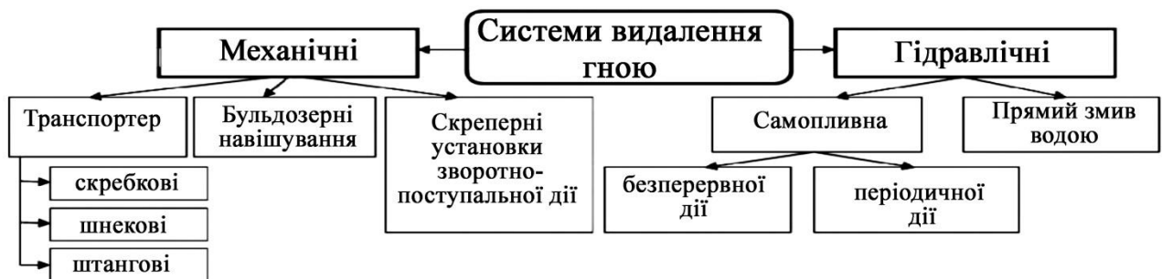
Рис 1.1 - Системи видалення гною зі свинарських приміщень
