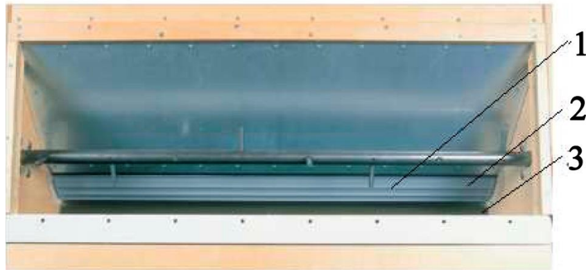
Рис. 1.2. Приймально-розподільний пристрій з рифленим валиком: 1 – живильний вал; 2 - лопатки; 3 - денце
