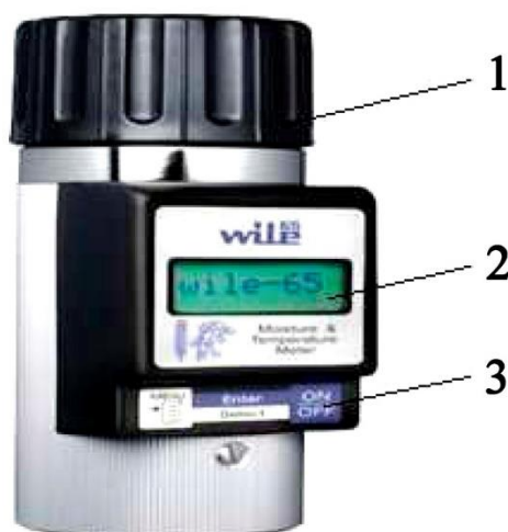
Рис. 3.4 – Вологомір «WILE-65»: 1 - кришка камери; 2 - цифровий дисплей; 3 - кнопки управління
