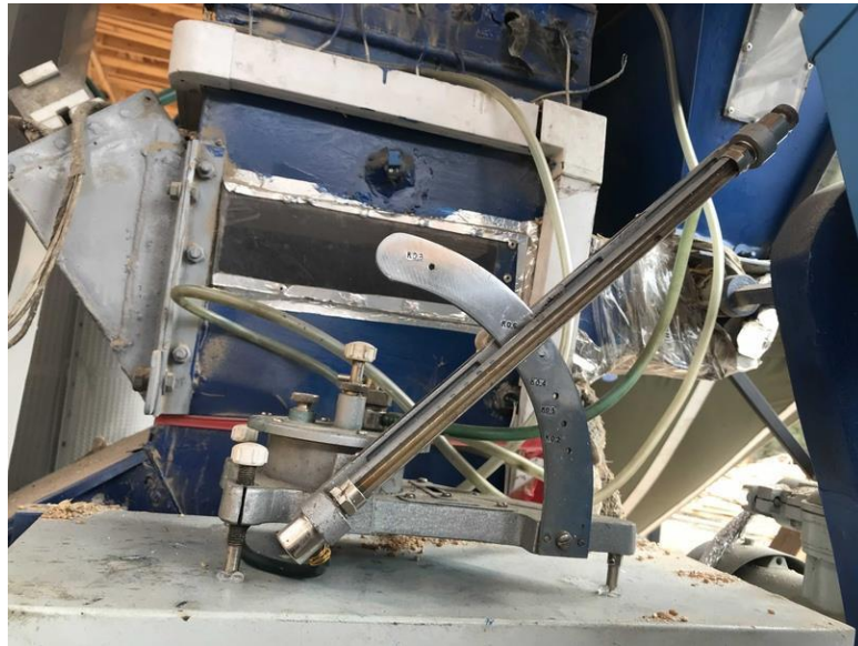
Рис. 3.2 - Багатогранний мікроманометр із похилою трубкою ММН-240
