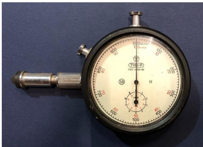
Рис. 3.1 - Тахометр часовий, ТЧ10-Р
