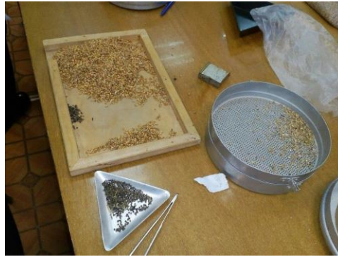
Рис. 3.10 - Визначення засміченості матеріалу в лабораторних умовах
