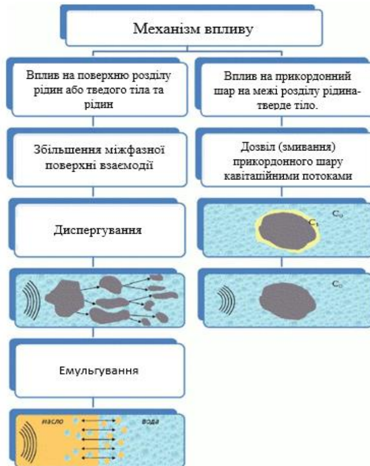
Рис. 2.5 - Механізм впливу на процеси, що відбуваються в гетерогенних середовищах
