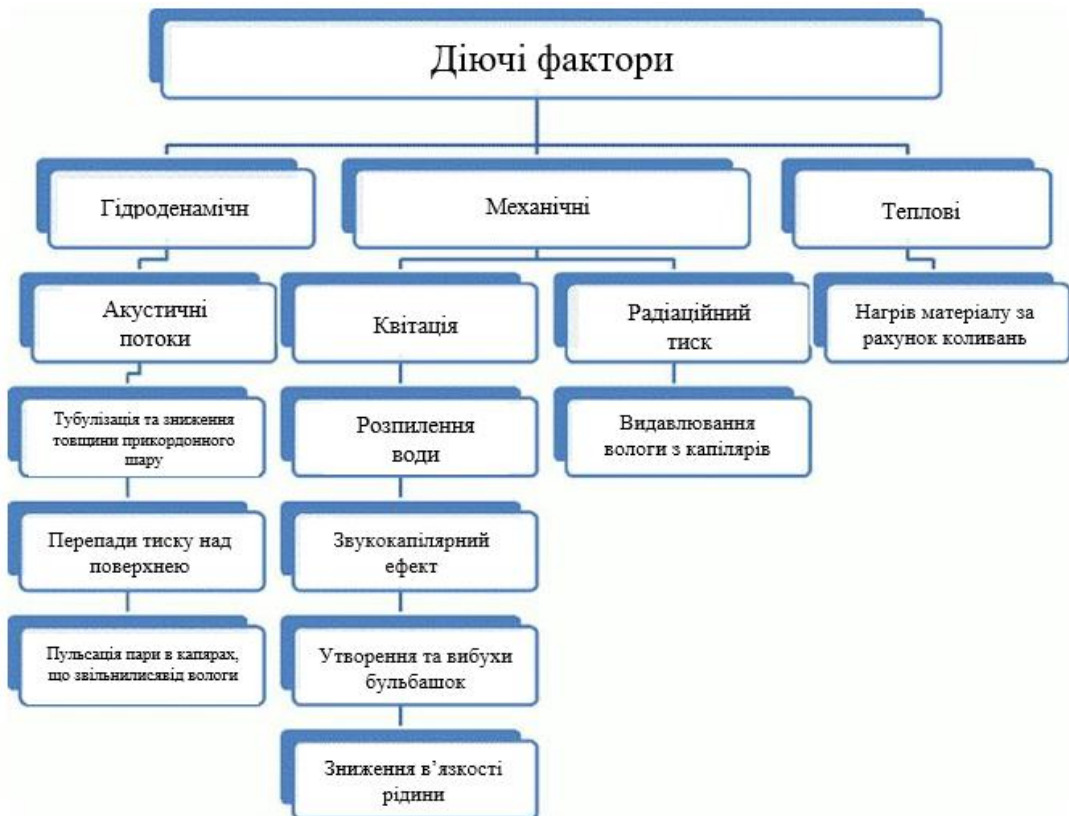
Рис. 2.6 - Фактори ультразвукового впливу на тісто в матриці преса
