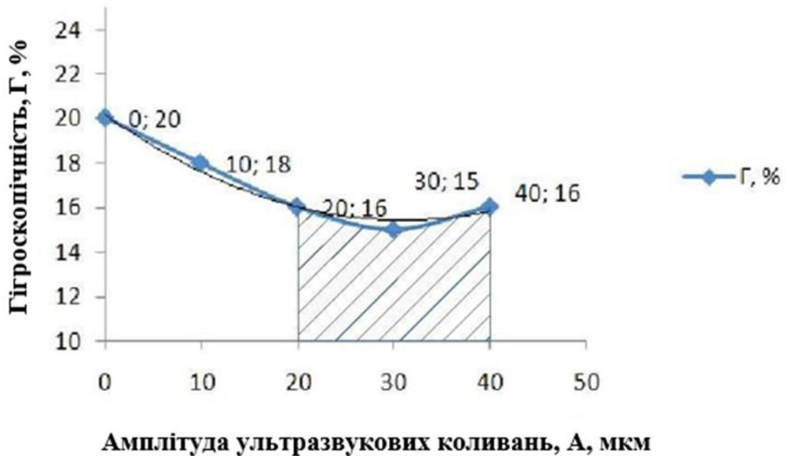
Рис. 4.8 - Залежність гігроскопічності макаронних виробів від амплітуди коливань ультразвукового випромінювача
