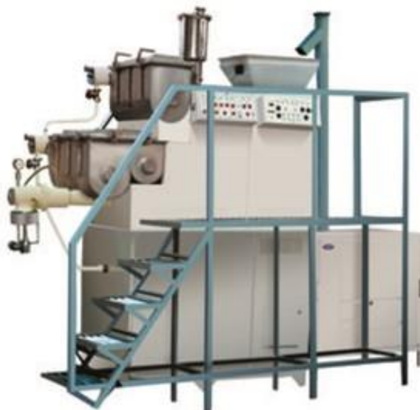
Рис. 1.3 - Прес вакуумний УІМІ-7,8/380-130 (Україна, Харків)
