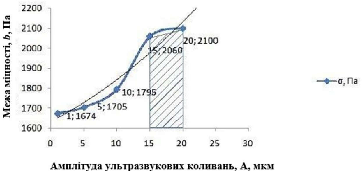
Рис. 4.6 - Залежність межі міцності макаронних виробів від амплітуди коливань ультразвукового випромінювача
