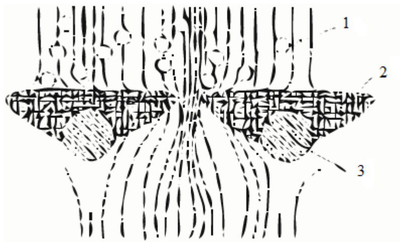
Рис. 2.1 - Схема утворення шару пилу при дії адгезії до волокон пористої перегородки: 1 – частки пилу; 2 - осад; 3 - волокно
