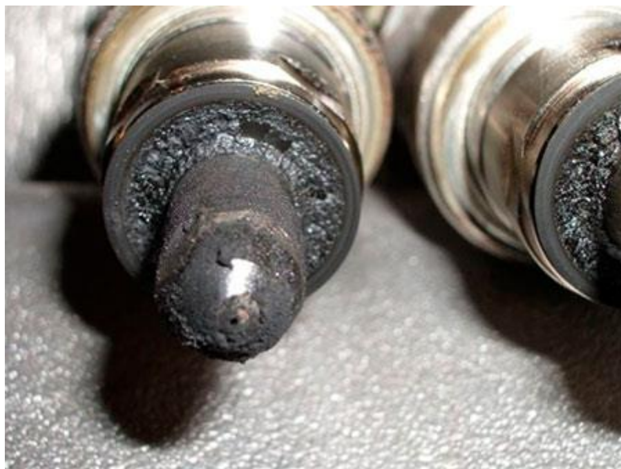
Рис. 1.4 - Засміченість паливних форсунок
