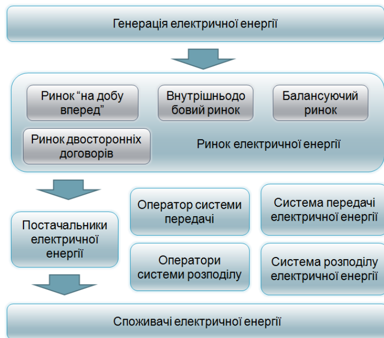
Рисунок 1.9 – Структурна схема системи передачі та розподілу електричної енергії, що запроваджується в Україні
