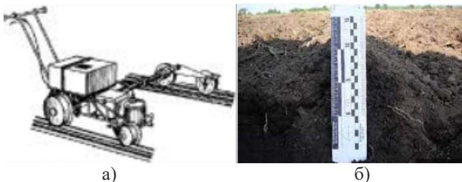
Рисунок 4.1 – Визначення мікрорельєфу поверхні поля за допомогою профілографу (а) і лінійки (б)
