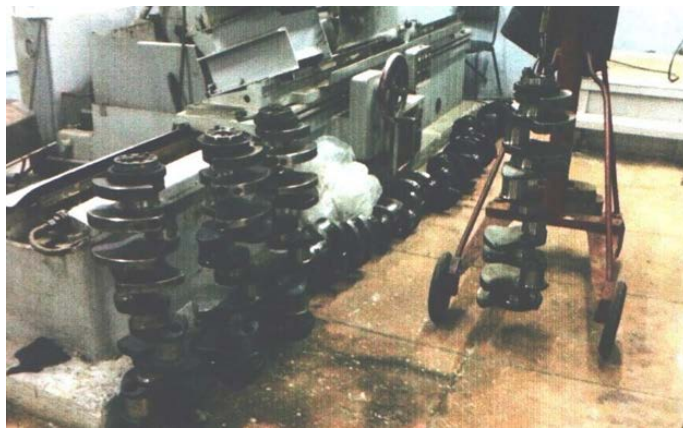
Рис. 3.7 – Дефектувальна ділянка колінчастих валів
