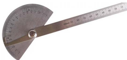
Рис. 3.4 – Шкала для зміни кута відхилення бойка за КВ
