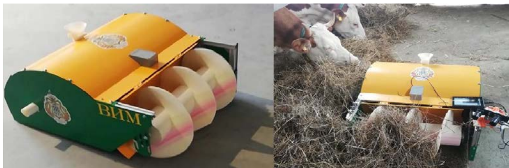
Рис. 3.6 – Експериментальний зразок роботизованого пристрою для внесення кормових добавок під час обслуговування годівниць на фермах
