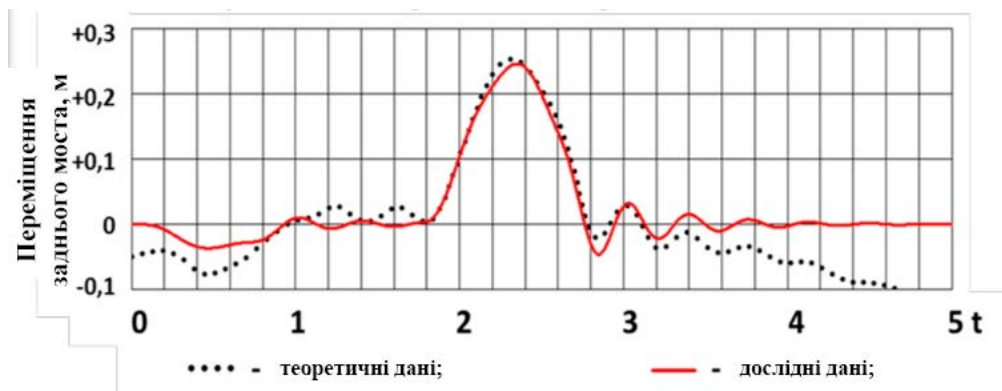
Рис. 4.11 – Вертикальні переміщення заднього моста
