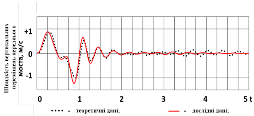
Рис. 4.6 – Швидкість вертикальних переміщень переднього моста під час переїзду одиничної нерівності
