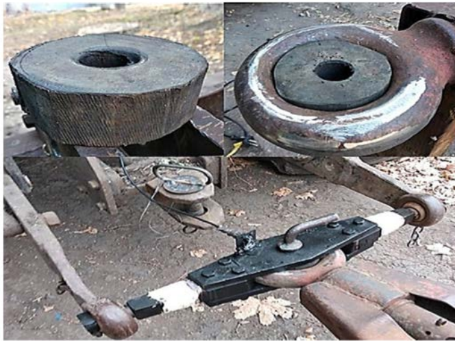
Рис. 3.14 – Демпфер для зниження ударних навантажень
