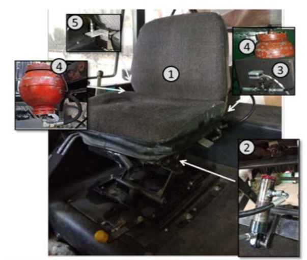
Рис. 3.2 – Загальний вигляд дослідної конструкції підвіски сидіння: 1 - сидіння оператора; 2 - гідроциліндр; 3 - керований дросель; 4, 5 - гідропневматичні акумулятори; 6 - датчик прискорень
