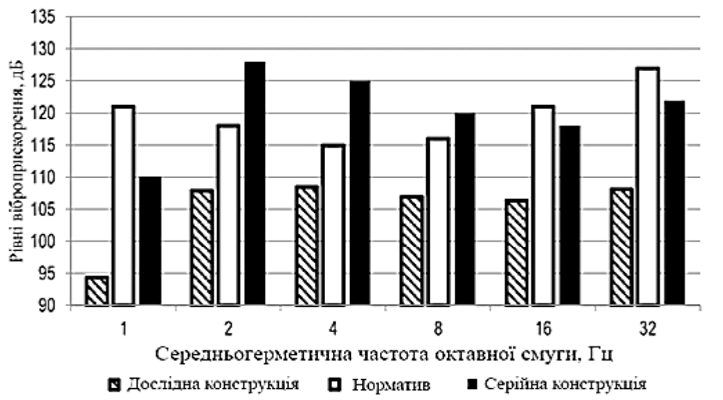
Рис. 1.11 – Порівняльні випробування вібраційної навантаженості робочого місця оператора ТТА у складі (МТЗ-1221.2 + 2ПТС-4,5) на ґрунтовій дорозі на швидкості 30 км/год
