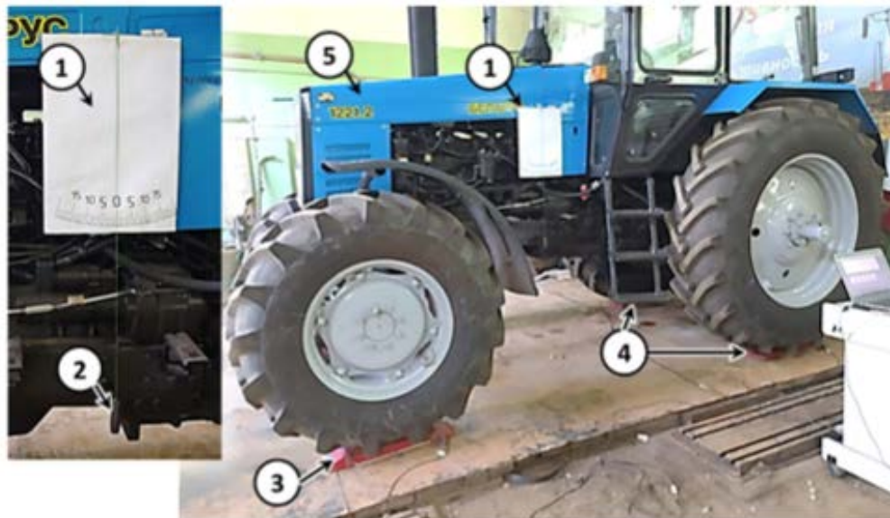
Рис. 3.9 – Вимірювання горизонтального положення центру ваги трактора: 1 - кутомір; 2 - схил; 3 – тензоваги переднього моста (до 1 т); 2 – тензоваги заднього моста (до 2 т); 5 – трактор
