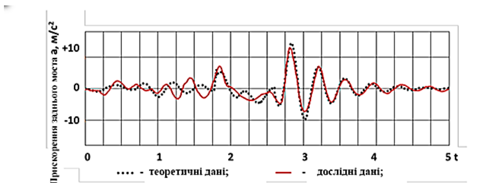
Рис. 4.5 – Прискорення заднього моста під час переїзду одиначної нерівності
