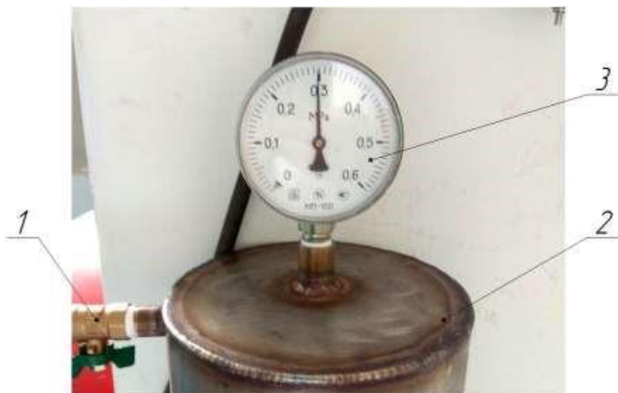
Рис. 3.4 - Місткість з дезінфікуючим розчином для визначення тиску робочої рідини: 1 – кран регулювальний; 2 – ємність з дезінфікуючим розчином; 3 – манометр МП-100
