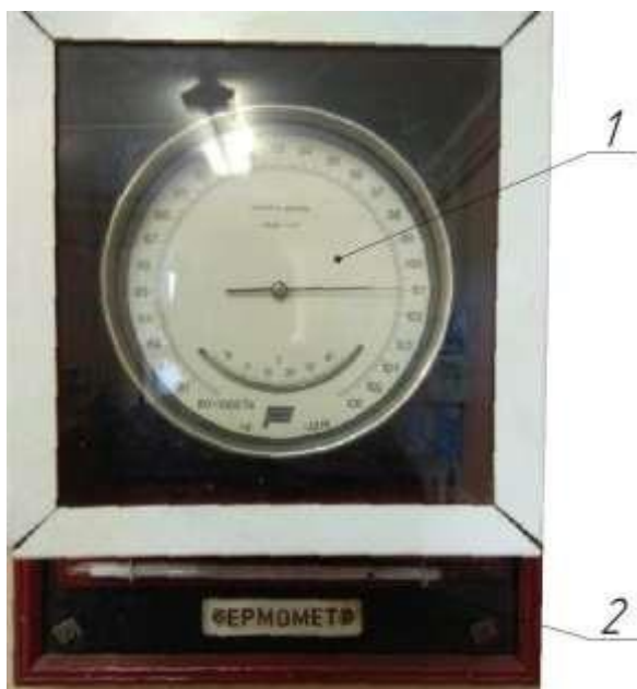
Рис. 3.5 - Барометр-анероїд БАММ-1: 1 – барометр; 2 – термометр
