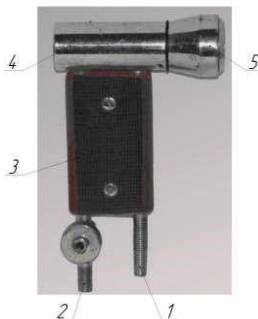
Рис. 3.7 - Пневматична вихрова аерозольна насадка ПВАН: 1 – штуцер подачі стисненого повітря; 2 – штуцер із краном для регулювання подачі рідини; 3 – рукоятка; 4 – корпус розпилювача; 5 – розпилювальна головка
