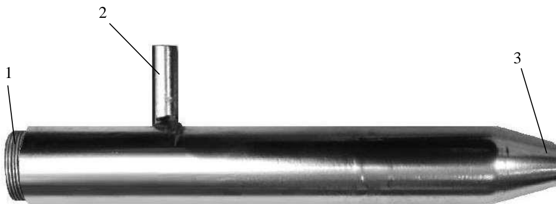
Рис. 3.8 - Вихровий інжекторний розпилювач (VIP): 1 – штуцер подачі гарячого повітря; 2 – штуцер для подачі дезінфікуючого розчину; 3 – розпилювальна головка
