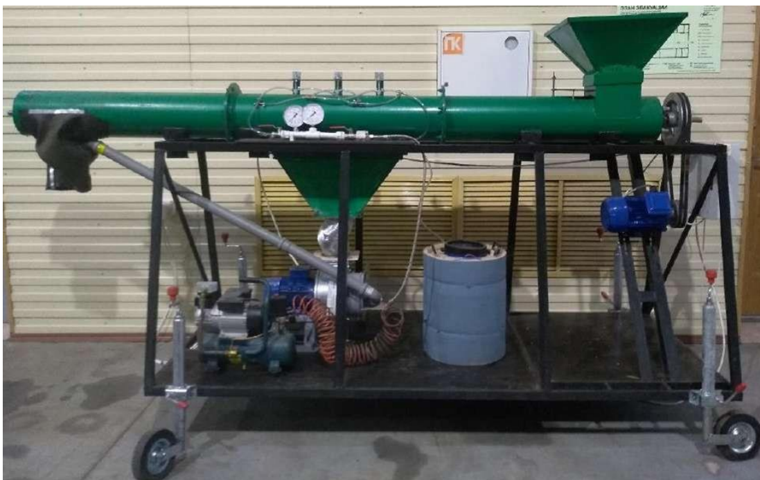
Рис. 3.5 - Експериментальний зразок установки для обробки насіння біопрепаратами
