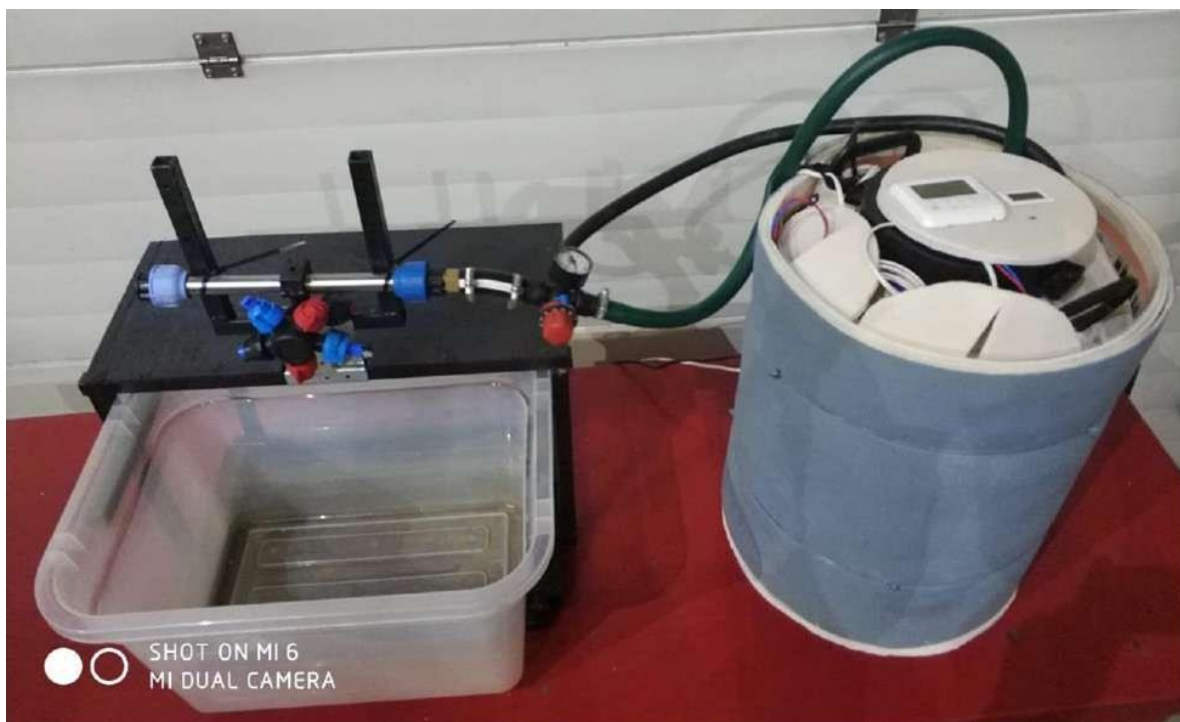
Рис. 3.2 - Загальний вид лабораторної установки вивчення впливу розпилювачів на життєдіяльність мікроорганізмів
