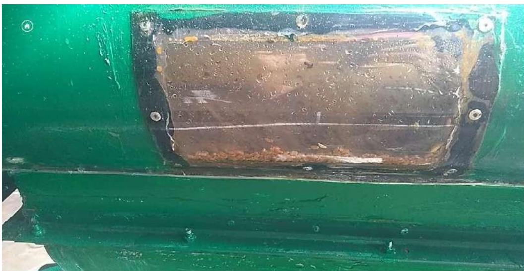
Рис. 4.6 - Оглядове вікно для контролю псевдозрідженого шару насіння у робочій камері установки
