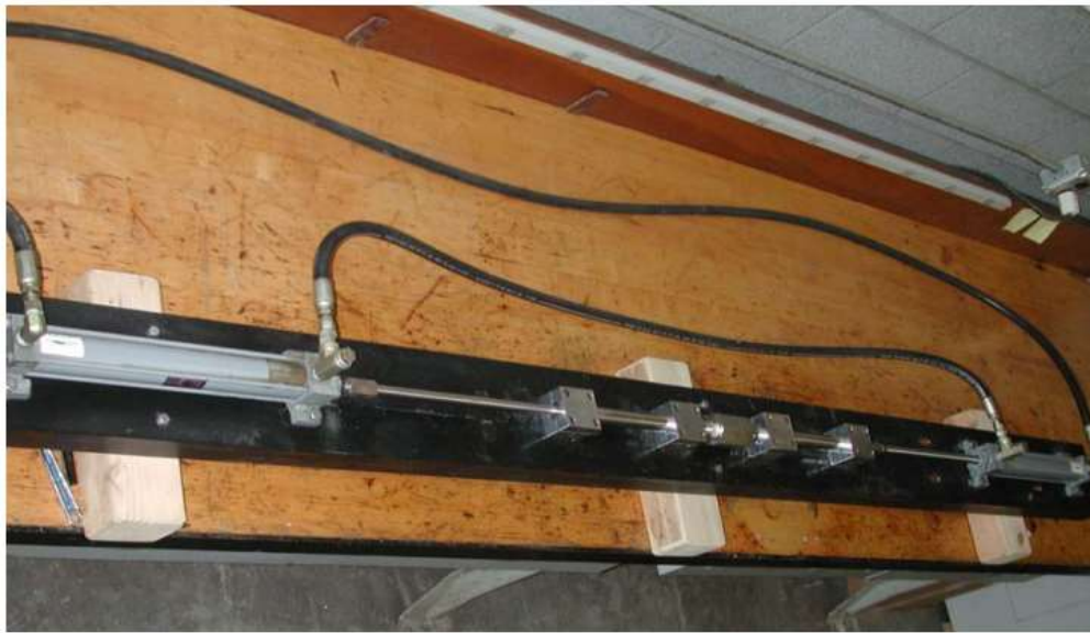
Рис. 3.2. Пристрій протилежного потоку поршнів, що використовується для проведення експериментів з оцінки вплив гідродинамічного стресу на пошкодження нематодами.
