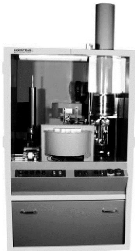
Рис. 2.6 - Вимірювальна установка для визначення реологічних і теплофізичних характеристик Coesfeld RT-1394H
