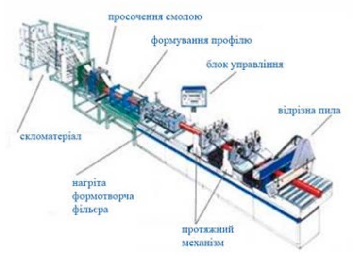
Рис. 1.11 – Схема створення деталей із ПКМ методом пултрузії
