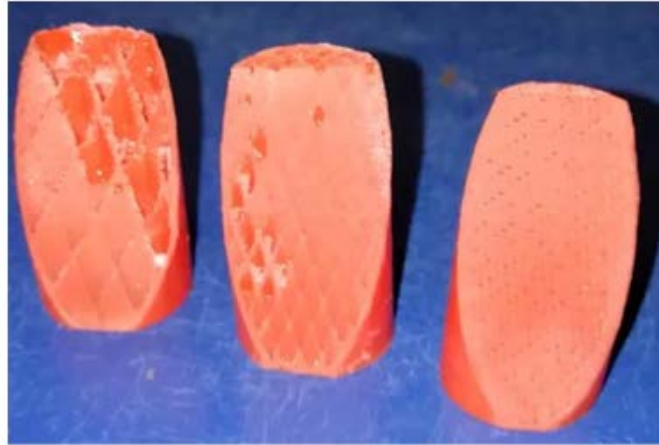
Рис. 4.2 – Якість просочення зразків з різним часом витримки, час витримки зліва направо: 10 хв; 20 хв; 30 хв
