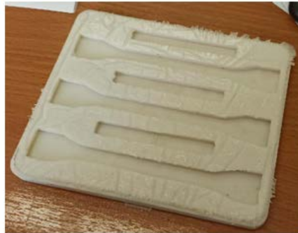
Рис. 3.9 – Силіконова форма для відливання зразків із чистої смоли
