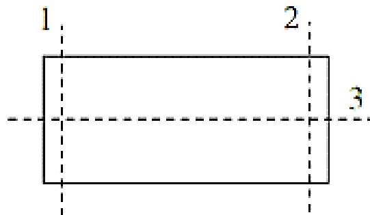
Рис. 3.3 – Схема розрізання просочених зразків
