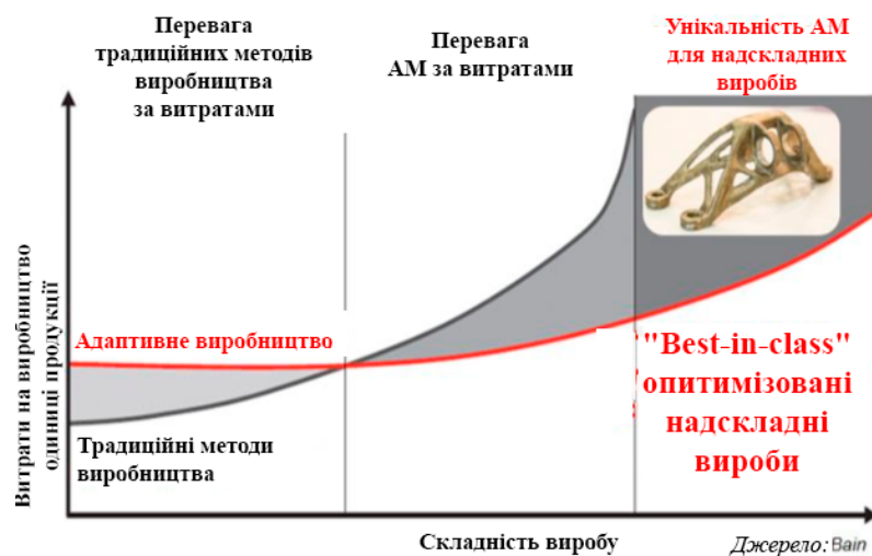
Рис. 1.23 – Схема зміни вартості виготовлення деталей методами адитивного виробництва залежно від складності виробів
