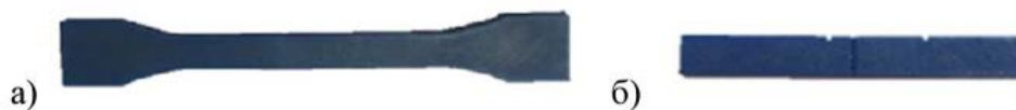
Рис. 4.6 – Форма зразків для дослідження пористості: а - зразки для подальших випробувань на розтягнення; б - зразки для подальших випробувань на ударну в'язкість
