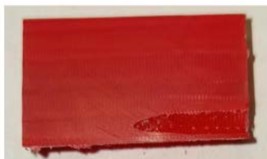
Рис. 4.3 – Типовий характер утворення пори в зразку
