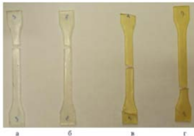
Рис. 4.8 – Зразки з чистої епоксидної смоли після випробувань на розтягнення: а - затверджувач ТЕТА, затвердіння за T = 24\text{ }^{\circ}\text{C} ; б - затверджувач ТЕТА, затвердіння за T = 90\text{ }^{\circ}\text{C} ; в - затверджувач ПЕПА, затвердіння за T = 24\text{ }^{\circ}\text{C} ; г - затверджувач ПЕПА, затвердіння за T = 90\text{ }^{\circ}\text{C}
