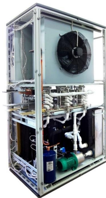
Рис. 1.2 – Випрямляч ГАЛС-6300P-12-УХЛ із рідинним охолодженням
