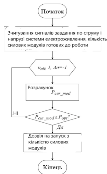
Рис 4.7 – Блок-схема алгоритму запуску системи електроживлення
