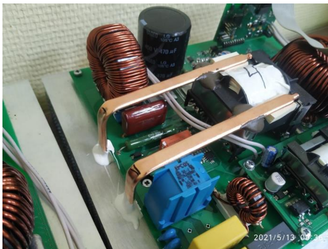
Рис. 4.4 – Фотографія перетворювача живлення для гальванічної установки з «класичним» трансформатором
