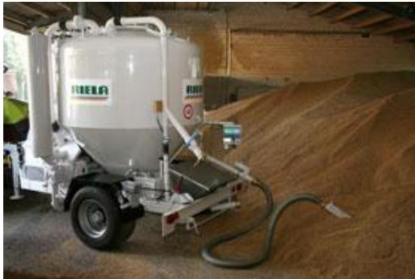
Рисунок 1.16 – Розміщення мобільного комбікормового агрегату (Riela GMA-3500) на зерновому складі сільгосп підприємства
