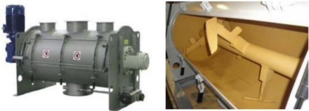
Рисунок 1.2 – Одновальний змішувач періодичної дії серії WBH
