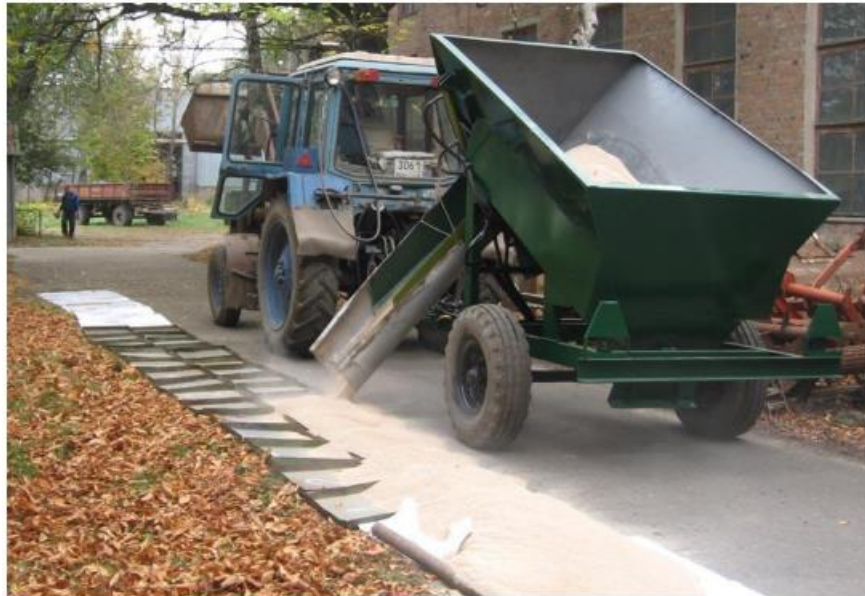
Рисунок 4.1 – Досліди щодо визначення нерівномірності видачі концкормів
