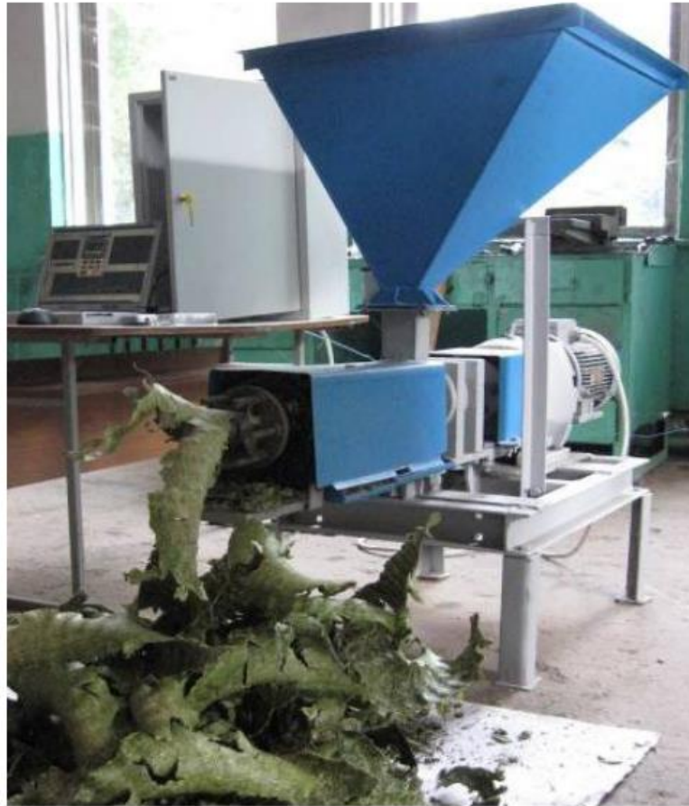
Рисунок 4.9 –Експандер кормовий ЕСП-75 у процесі роботи
