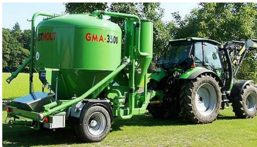
Рисунок 1.15 – Мобільний причіпний комбікормовий агрегат Riela GMA-3500, що агрегатується з трактором
