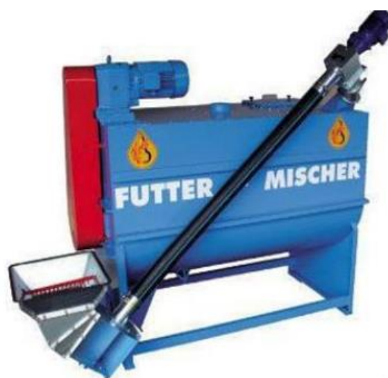
Рисунок 1.7 – Стрічковий змішувач фірми HIMEL Maschinen
