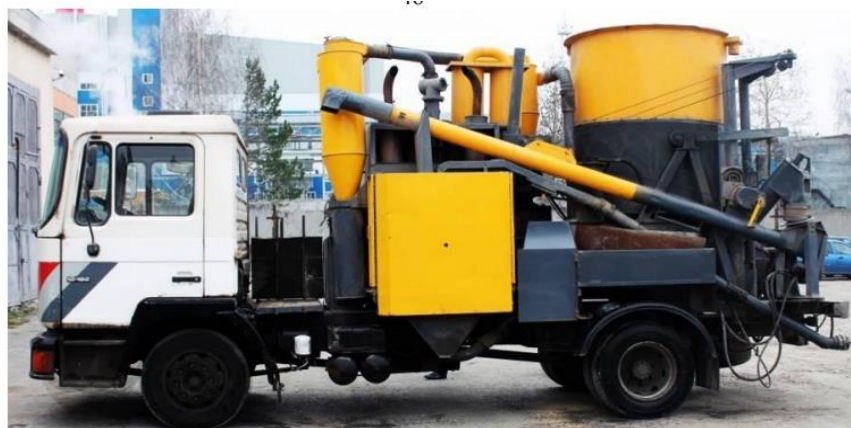
Рисунок 1.19 – Мобільний самохідний комбікормовий агрегат на шасі вантажного автомобіля
