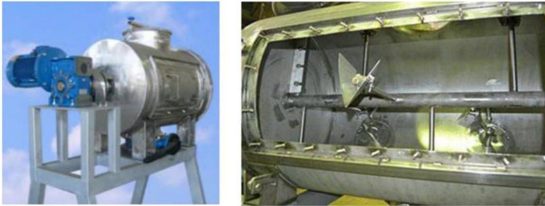
Рисунок 1.5 – Змішувач із плугоподібними робочими органами
