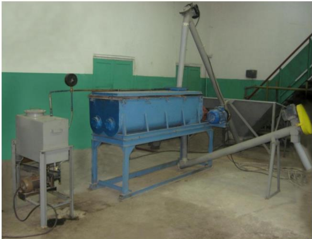
Рисунок 4.4 – Зовнішній вигляд експериментальної установки для дослідження сумішоутворення сипких та рідких інгредієнтів
