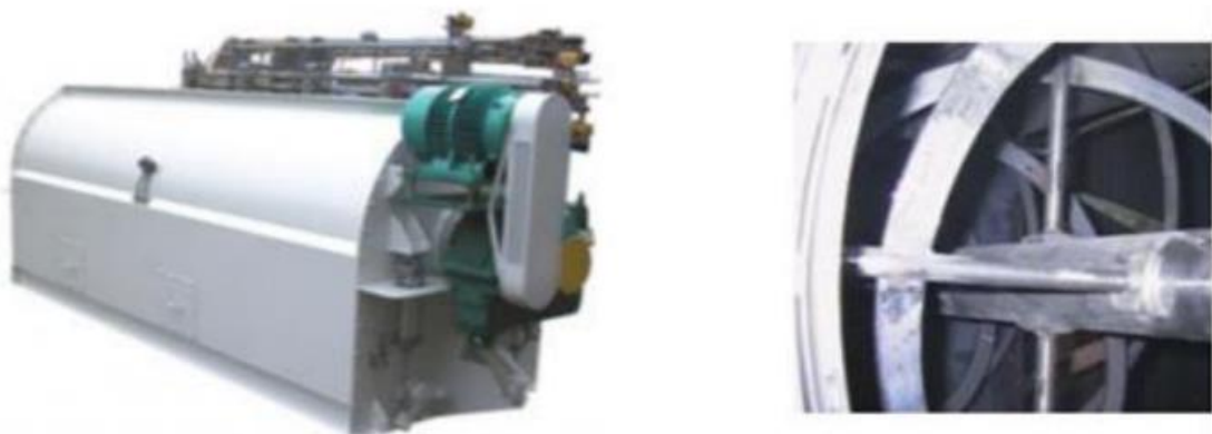
Рисунок 1.10 - Стрічковий змішувач Wynveen International (Голландія) та його змішуючий вал.
