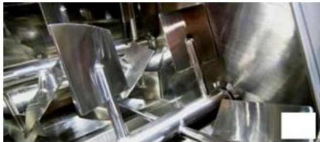
Рисунок 1.8 - Робочі органи змішувача двовального CR 1 Wynveen International
