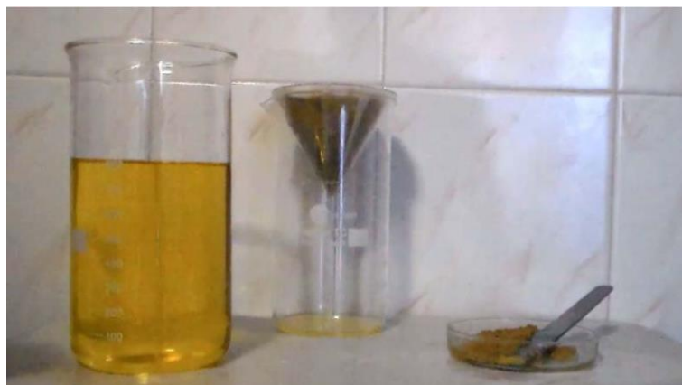
Рис. 4.10 Відбілювання соняшникової олії при нагріванні.
