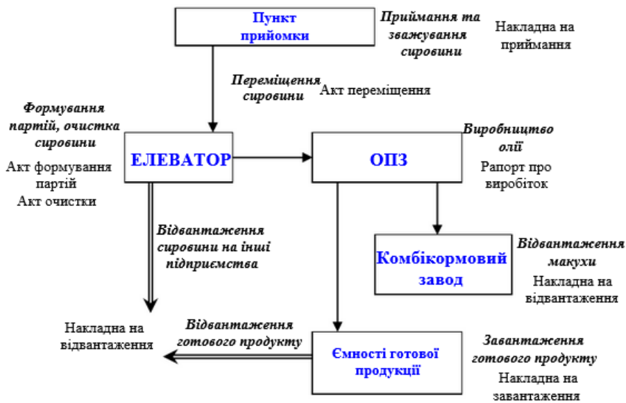
Рис. 1.6 Загальна схема процесу виробництва олії
