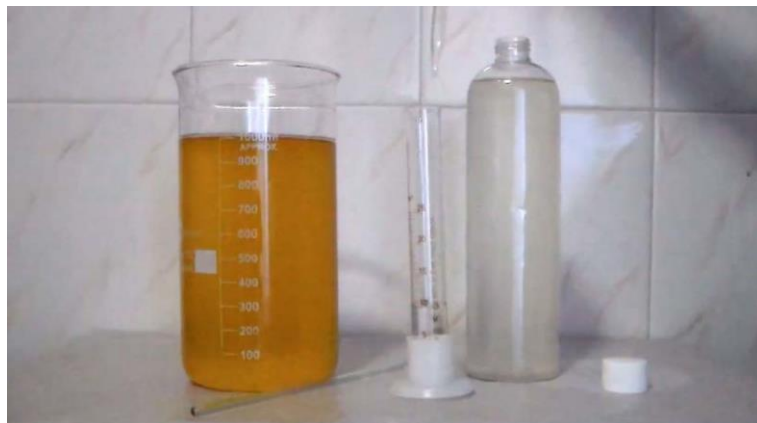
Рис. 4.6 - Розчиняємо реагент-коагулянт (РК 1) у воді, перемішуємо та додаємо цей розчин у відфільтровану олію, після чого перемішуємо 30 хв. (рис. 3.6).
