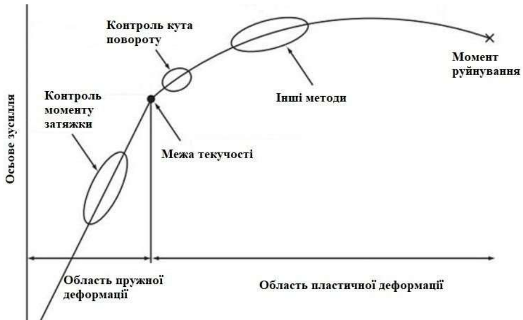
Рис. 1.19. Застосування різних способів з'ятування
