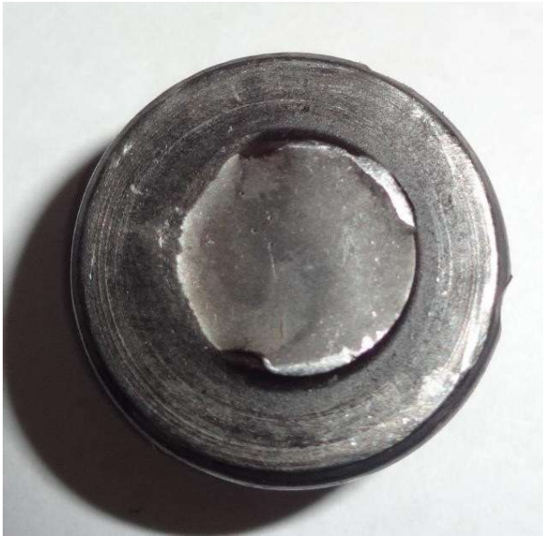
Рис. 3.2. Відламана головка шатунного болта та зона початку розвитку мікротріщини
