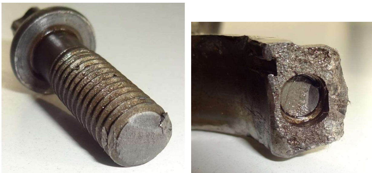
Рис. 3.1. Руйнування шатунного болта внаслідок виникнення мікротріщини, яка в свою чергу виникла із-за перетягування з'єднання
