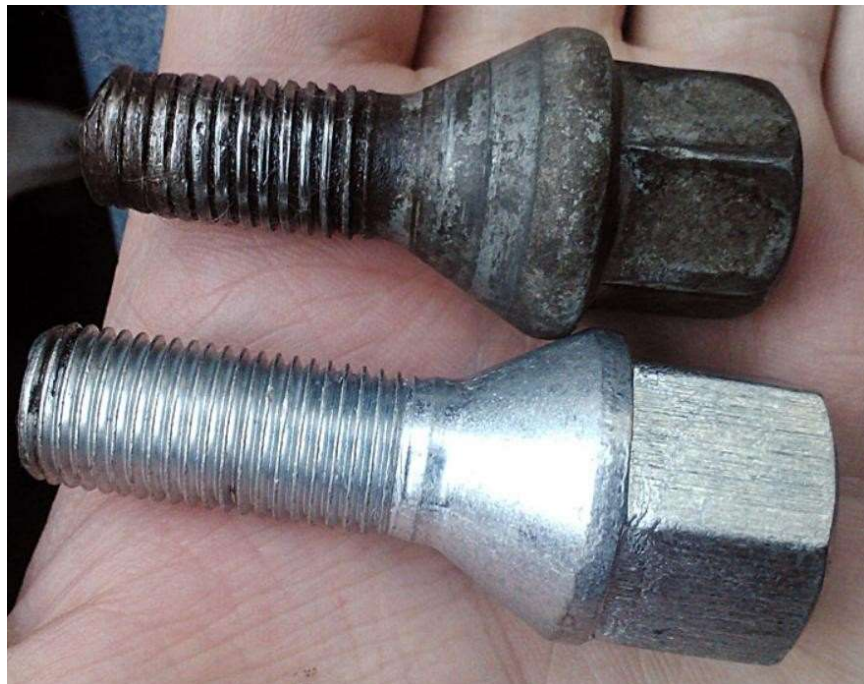
Рис. 3.3. Знос різьби болта кріплення колеса внаслідок недотягування
