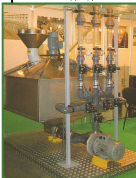
Рис. 107. Автоматичне приготування рідких кормів та замінників цільного молока
