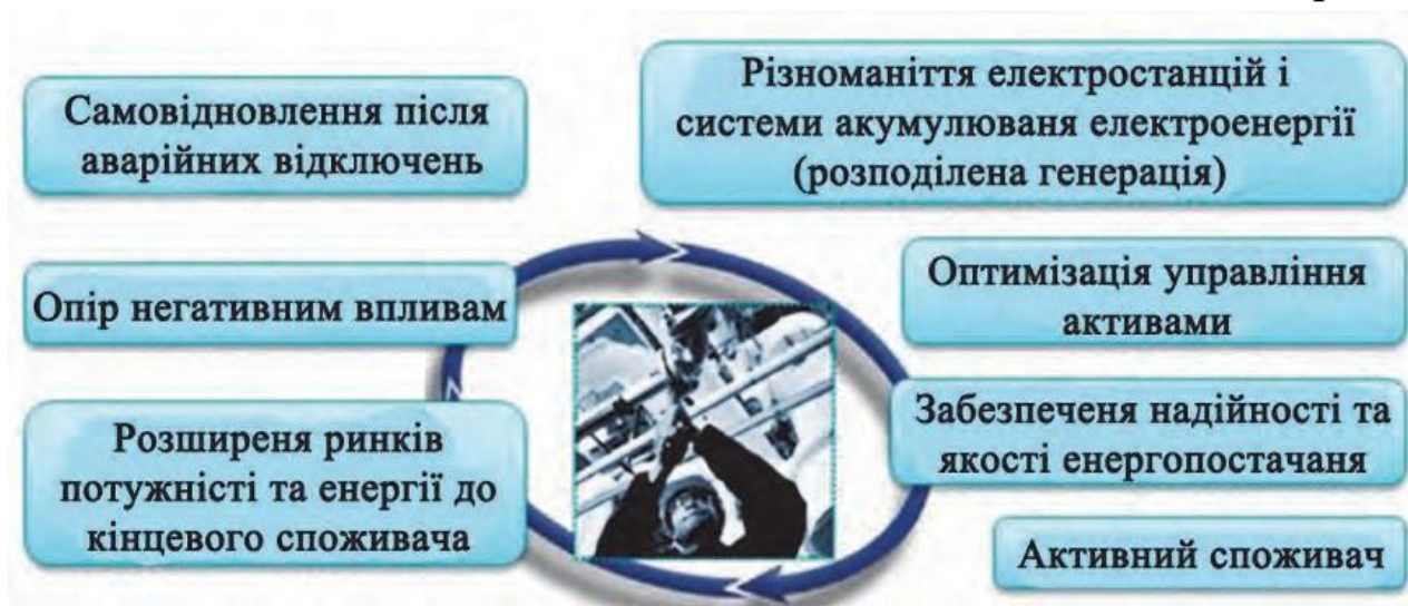
Рисунок 2 – Характеристики, які необхідні для досягнення ключових вимог Smart Grid
