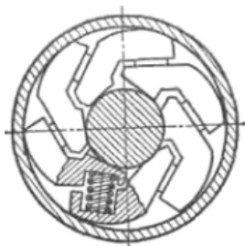
Рис. 3.2. Наскрізний струмоз'ємний розеточний контакт.
